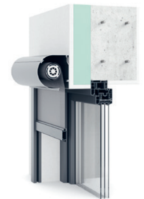
VS-Z rund. Rollgeformte Blenden und stranggepresste Revisionsblende, Einbausituation WDVS.
